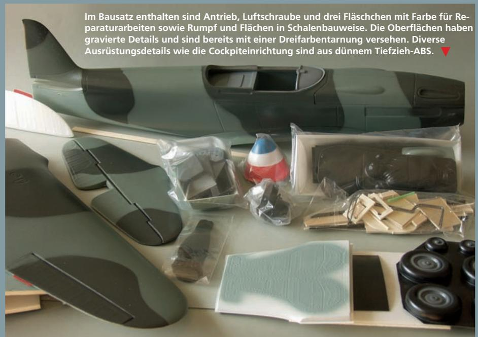
Im Bausatz enthalten sind Antrieb, Luftschraube und drei Fläschchen mit Farbe für Reparaturarbeiten sowie Rumpf und Flächen in Schalenbauweise. Die Oberflächen haben gravierte Details und sind bereits mit einer Dreifarbenanstrich versehen. Diverse Ausrüstungsdetails wie die Cockpitrichtung sind aus dünnem Tiefzieh-ABS. ▼
