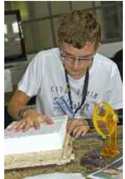
Nachschub wird benötigt. Sebastian schneidet hauchdünne Scheiben für die nächsten Saalflugmodelle von einem Styroporblock. Man beachte den Ventilator zur Kühlung des Schneiddrahts.
